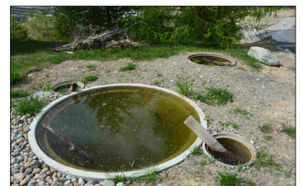
Abb. 12: Flawil, Burgauerfeld: Verschiedene Betonschächte als Versuchsanordnung. (J.Barandun)
